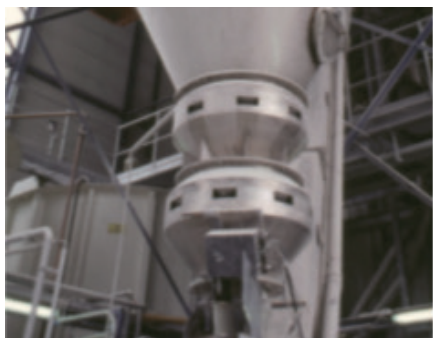
用于造粒粉制备的喷雾造粒塔
